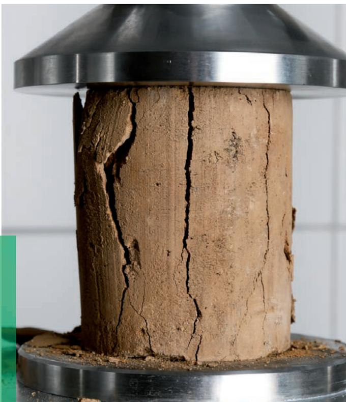
*Einaxialer Druckversuch an einer bindemittelstabilisierten Bodenprobe*
