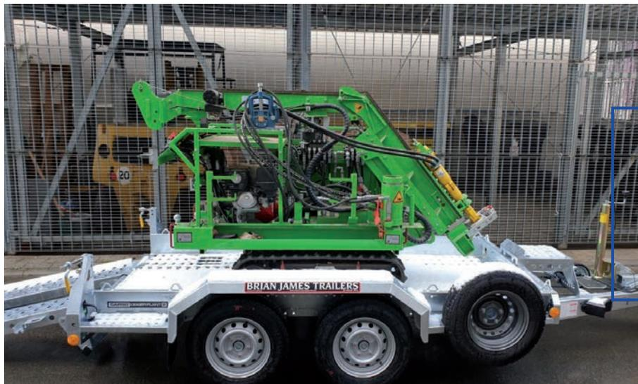
Seit diesem Jahr haben wir für unsere Felderkundungen im Rahmen von Forschungs- und Erkundungsleistungen eine Sondierdraupe für Bohr- und Rammsondierungen, die wir mit Transporter und Anhänger zum Baufeld fahren.
